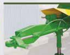
APOYO DELANTERO Y LANZA DE MANDO DE EJE DIRECCIONAL HIDRÁULICOS
